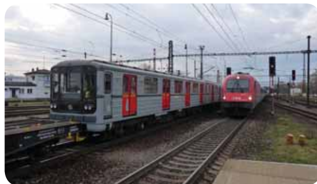
Vlak ve finální sestavě vlakové lokomotivy 181.024-1, 25 vozů Falls, zavěšená lokomotiva 753.727-7 se svými původními vozy 2xSmmp - 2x81-717.1 - 1xSmmp (viz předchozí foto), o celkovém počtu 130 náprav a přibližně 987 t na trase Praha - Běchovice (13:00) Pardubice (16:40) Česká Třebová (18:15) Ostrava hl. n. (0:20) žst. Ostrava-střed (0:45). Foto: Ing. Petr Pokorný
