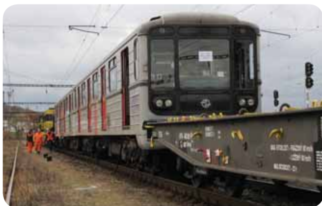
Příprava vlaku před cestou do Ostravy. Právě probíhá propojení brzdových hadic krycích vozů (6. 11. 2010 – 14.51).
