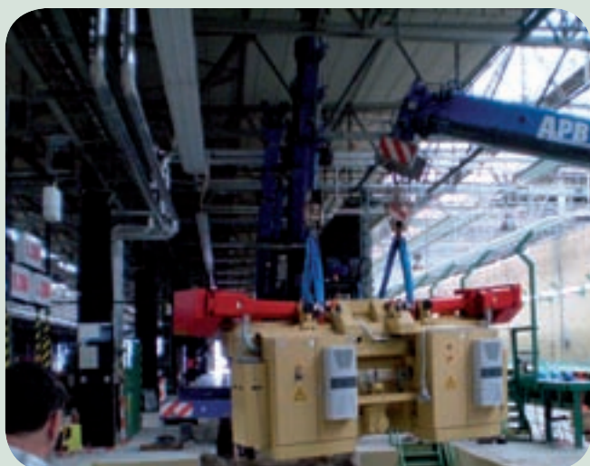
Pomocí dvou autojeřábů se soustruh usadil na své místo.
