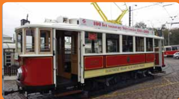
Vůz 2272 těsně před svojí obnovenou premiérou stojí 22. října 2009 připraven na nádvoří střešovické vozovny. Vůz má v zásadě původní podobu, ale protože musí splňovat některé technické podmínky pro dnešní provoz v pražských ulicích, má například světelné ukazatele směru a pantograf jako v době, kdy dojezdil.
