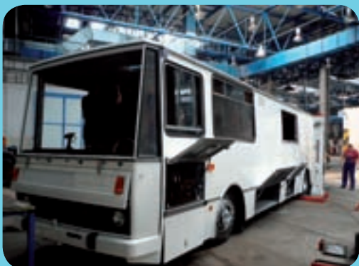
6 V lakovně dostal Kinobus nový kabát, poté přišla na řadu oprava elektroinstalace. V zadní části autobusu se nachází skladový prostor pro lavice a promítací plátno. V přední části najdeme servisní prostor pro posádku.
