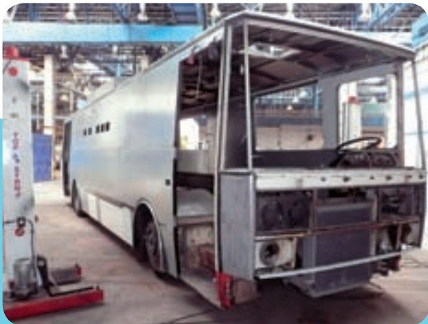
4 Tu následně překryly vnější plechy.
