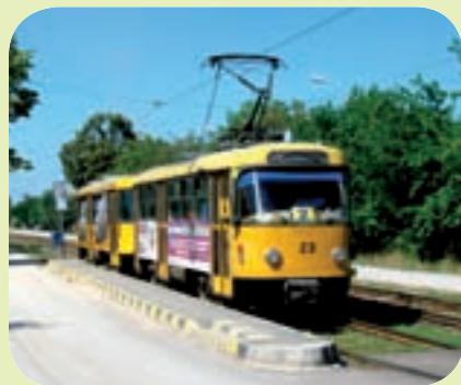
Ex Drážďanské vozy ev. č. 23 + 123 fotograf zachytil na zastávce Lipovei II. Vzhledem k použití otevřeného kolejového svršku vznikly z obousměrné komunikace dvě obousměrně pojezděné jednosměrné komunikace. Dále stojí za povšimnutí „bezbariérová“ úprava zastávky.
