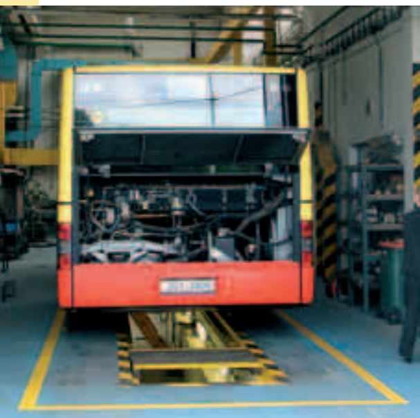
Motor autobusu na LPG. Všechny autobusy v Mostě a Litvínově jezdí na LPG.
