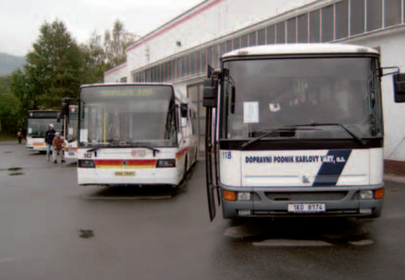
Současné autobusy Dopravního podniku Karlovy Vary na výstavce v areálu garáží při Dnech otevřených dveří. V popředí zájezdová Karosa C 955 a nízkopodlažní Škoda 21 Ab.
