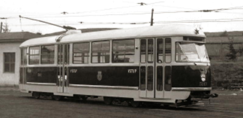
Tak vypadala ta úplně první tramvaj typu T1 (č. 5001). Snímek byl pořízen ve vozovně Motol a jistě každého zaujme tyčový sběrač, kterými byly „té jedničky“ původně vybaveny.
