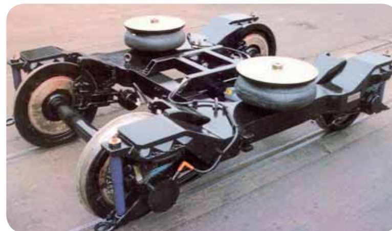
Netrakovní podvozek spol. BREL Limited typu „Series 3“, který měl být upraven pro zástavbu trakčních motorů a použit jako trakční podvozek pro nové vozy pražského metra
