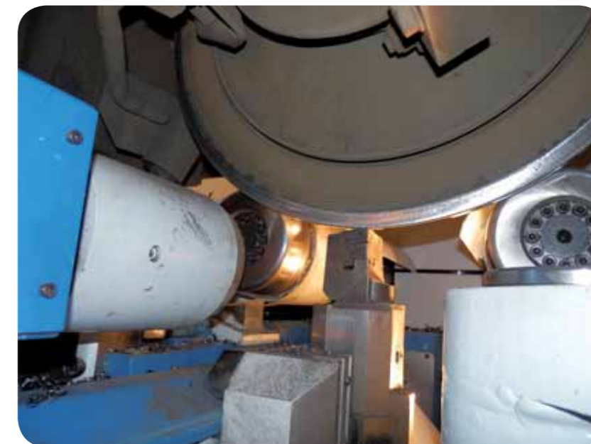
Kolo drží ve vzduchu dvě kladky (po stranách) a zároveň s ním otáčí. Nůž ve tvaru kostky (uprostřed) soustruží žádaný profil
