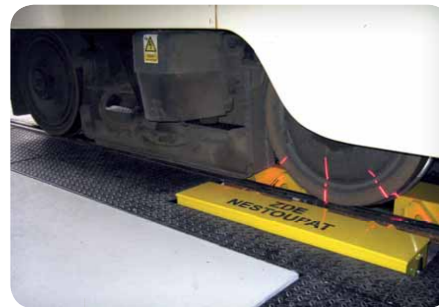
Probíhá bezkontaktní laserové měření
