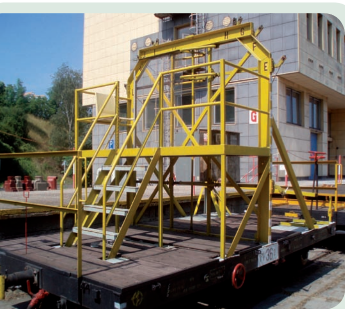
Šablona průjezdného průřezu r.v. 1973.
