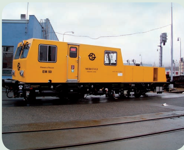
Měřicí vůz Plasser EM 50 r.v. 2005.
