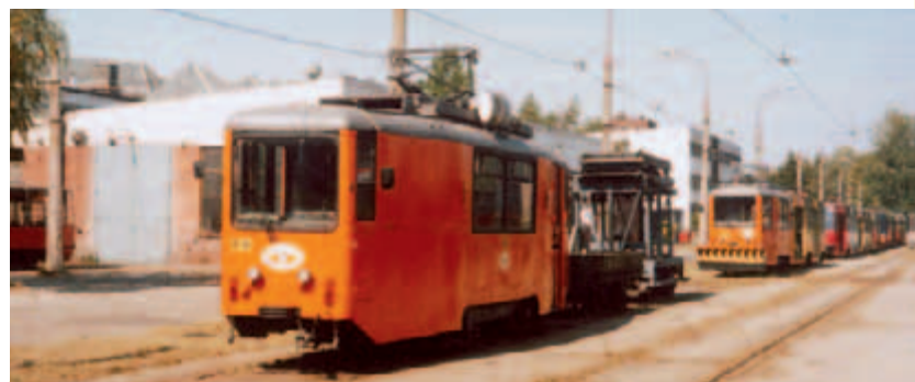
Služební vůz R 91 je vybaven také diesellovým motorem. Na střeše vozu je patrný výfuk.
