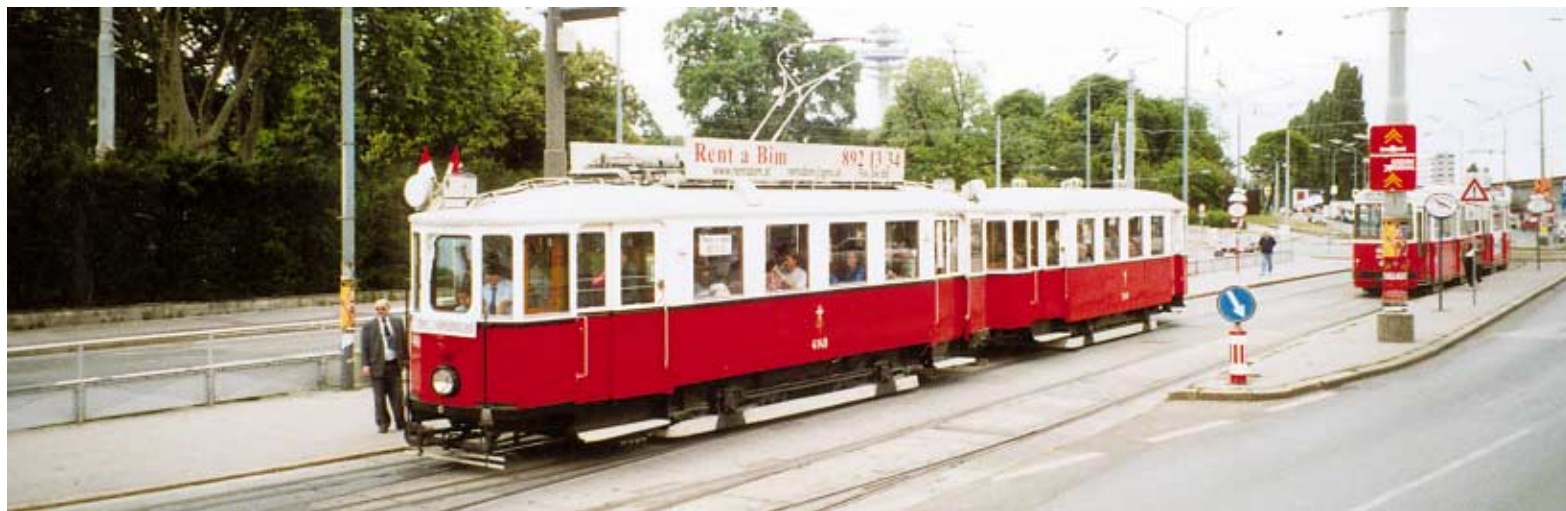
„Typická vídeňská“ souprava složená z motorového vozu M a vlečného vozu m u Jižního nádraží.
