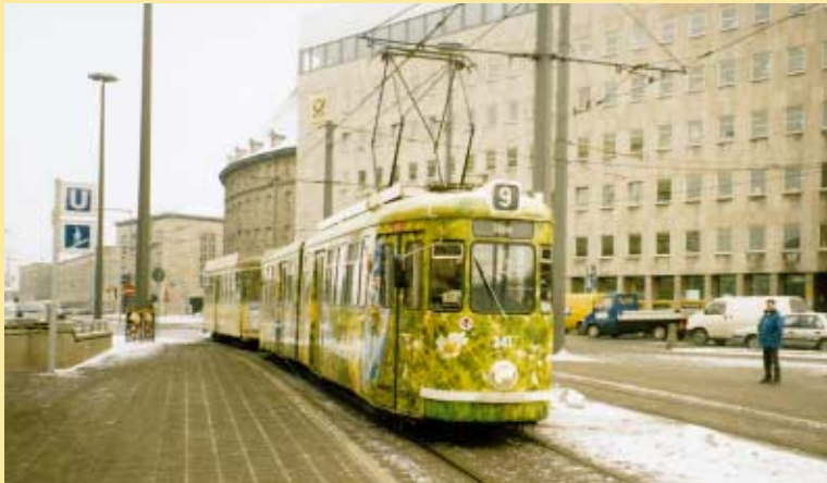
Článkový vůz 341 (série 301 – 356, MAN 1962/66) se čtyřnápravovým vlečným vozem.
