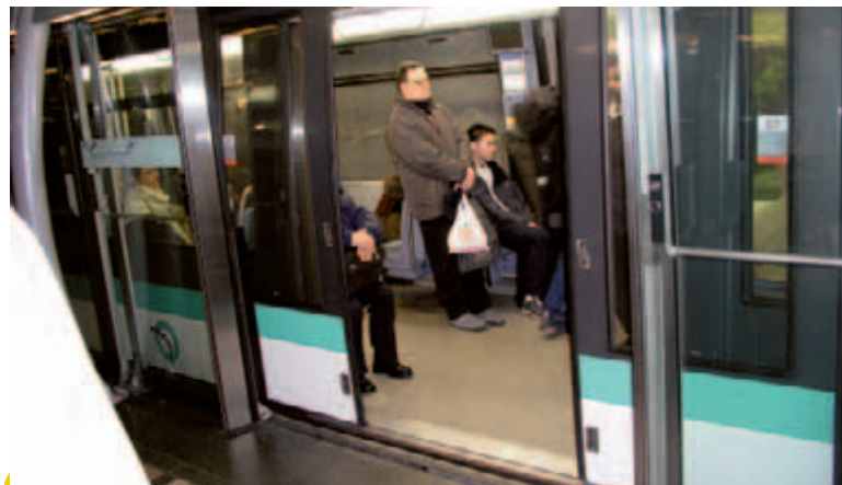
V článku zmíněná skleněná nástupištní stěna s posuvnými dveřmi. Na obrázku je možné vidět již otevřené staniční dveře a právě se otevírající dveře vlakové soupravy.
