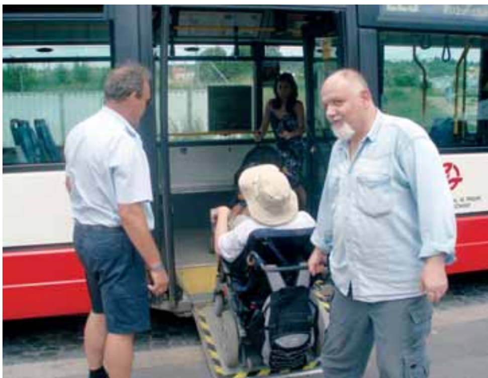
Řidič musí opustit kabinu, aby vysunul vozíčkáři nástupní plošinu.
