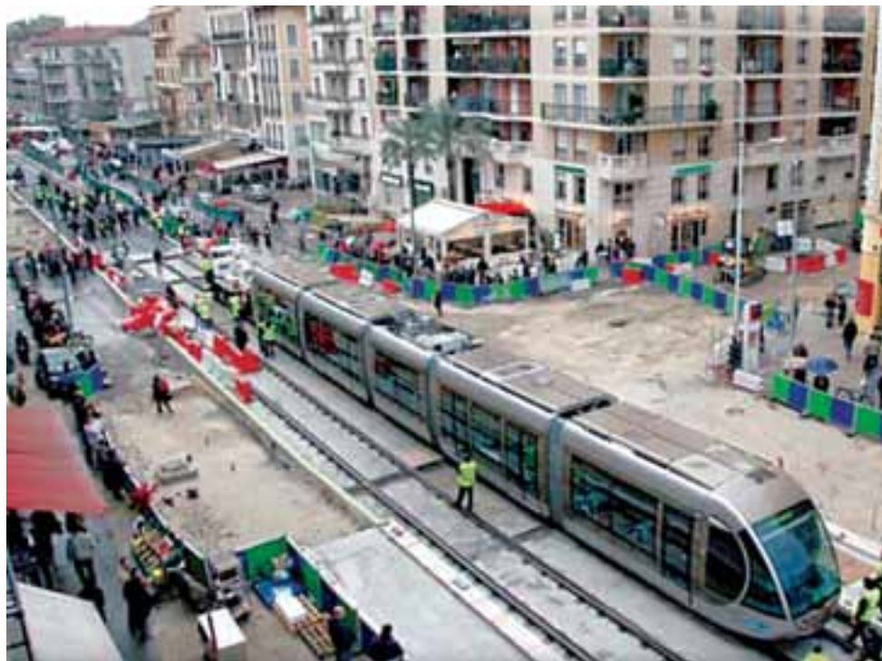
Představení nové tramvaje veřejnosti proběhlo na téměř dokončeném úseku v centru města. Trolejové vedení ještě nebylo zavěšeno, takže tramvaj musela být dotažena cizí silou. Foto © CANCA
