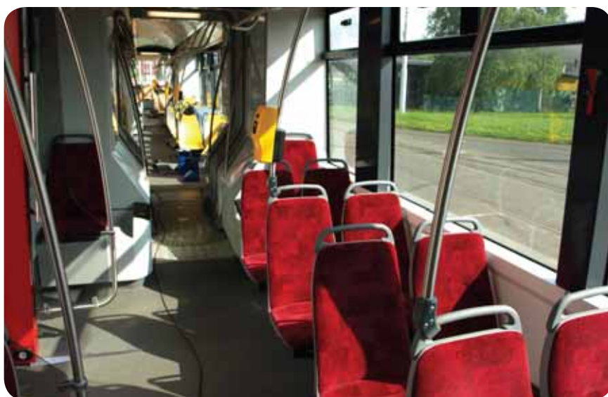
Jeden z možných zkoušených provedení sedaček v tramvaji, vpředu textilní, vzadu provedení plastové.
