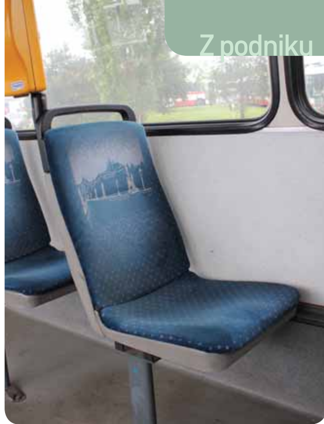
Toto provedení s „plyšovým“ čalouněním se v autobusech neosvědčilo.
