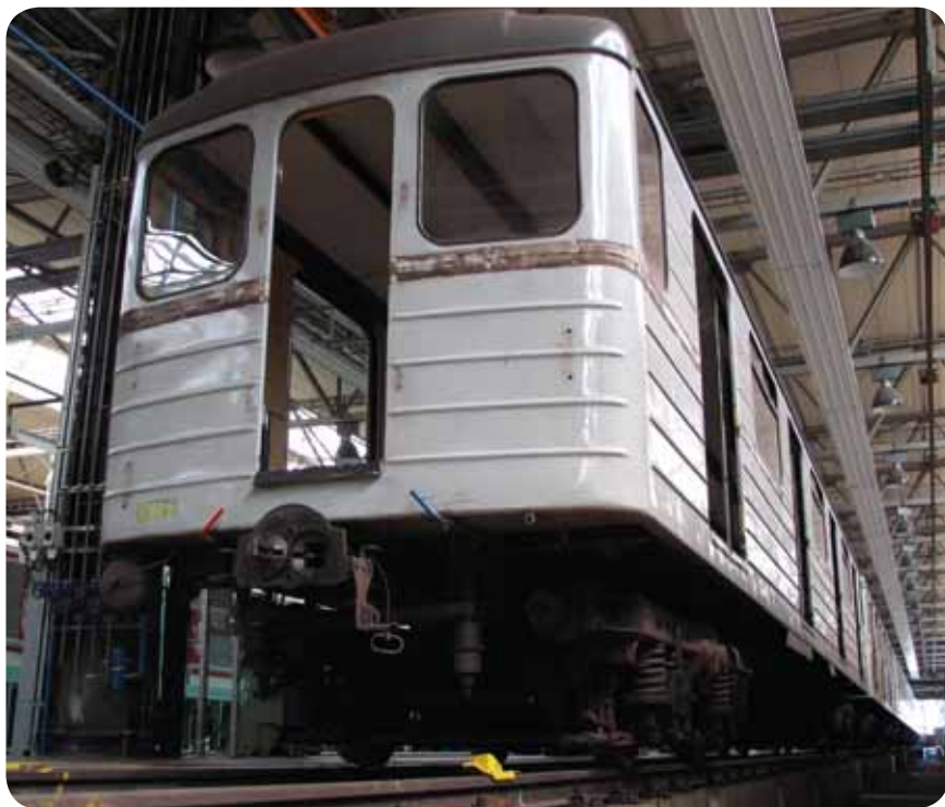
Odstrojená souprava vložených vozů 81-714.1 evidenčních čísel 2656, 2680, 2681, 2683 a 2684 – odstavená na 36. koleji depa Kačerov.
