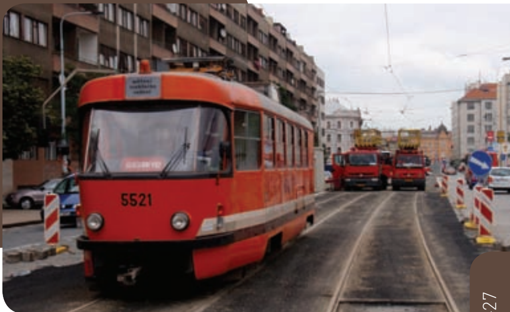
Měřicí vůz (tzv. pomeranč) č. 5521 vyčkává u Sparty na propojení trolejí (v pozadí vozy Vrchního vedení) a první jízdu v úseku. Neděle 28. červen 2009.
