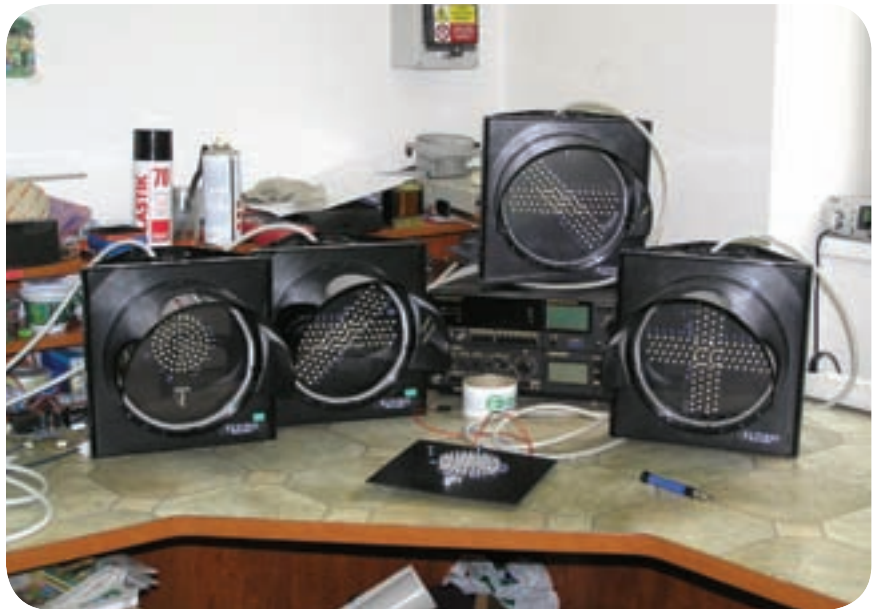
Návěstidla byla sestavena v dílně Eltodo DS v Čerčanské ulici. Osazení jednoho návěstidla diodami trvá cca 1 den.
