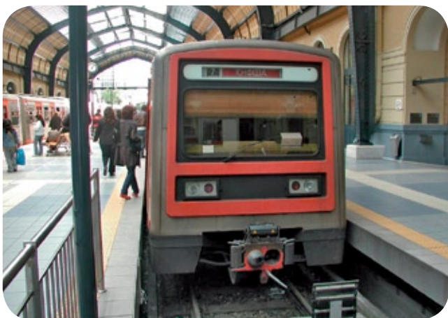
← ↑ Na trase 1 jezdí jeden typ vozů, ale jeho dvě generace. Liší se od sebe především designem čel – starší (nahore) a novější (vlevo), potom elektrovýzbrojí, typem zasklení a otvírání oken, kokpity strojvedoucích a pak detaily v interiéru.
