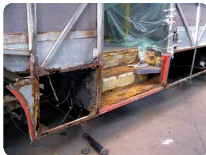
Stav jednoho z autobusů po demontáži bočních plechů s ukázkou stavu schodů
