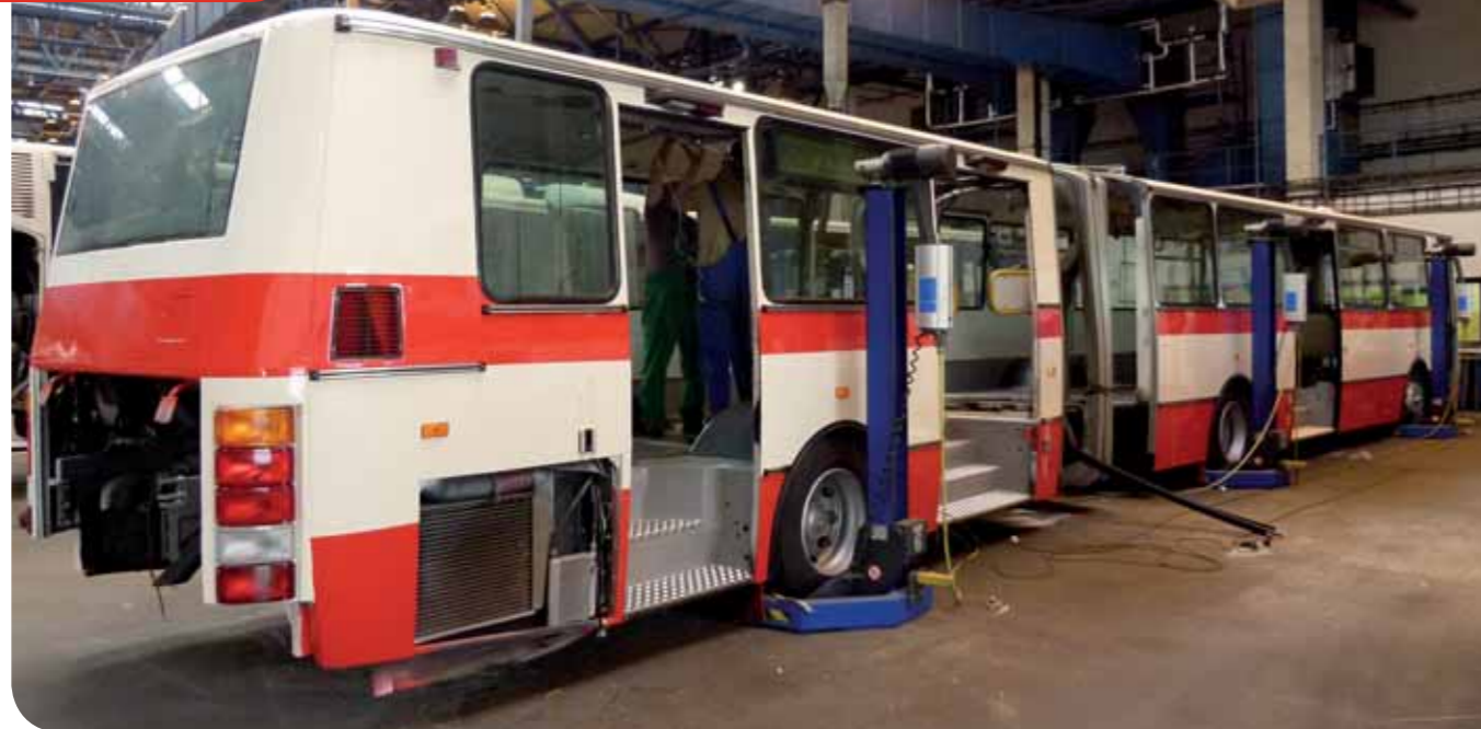
Kloubový autobus Karosa v procesu částečných oprav – již v novém laku a ve fázi dokončovacích prací
