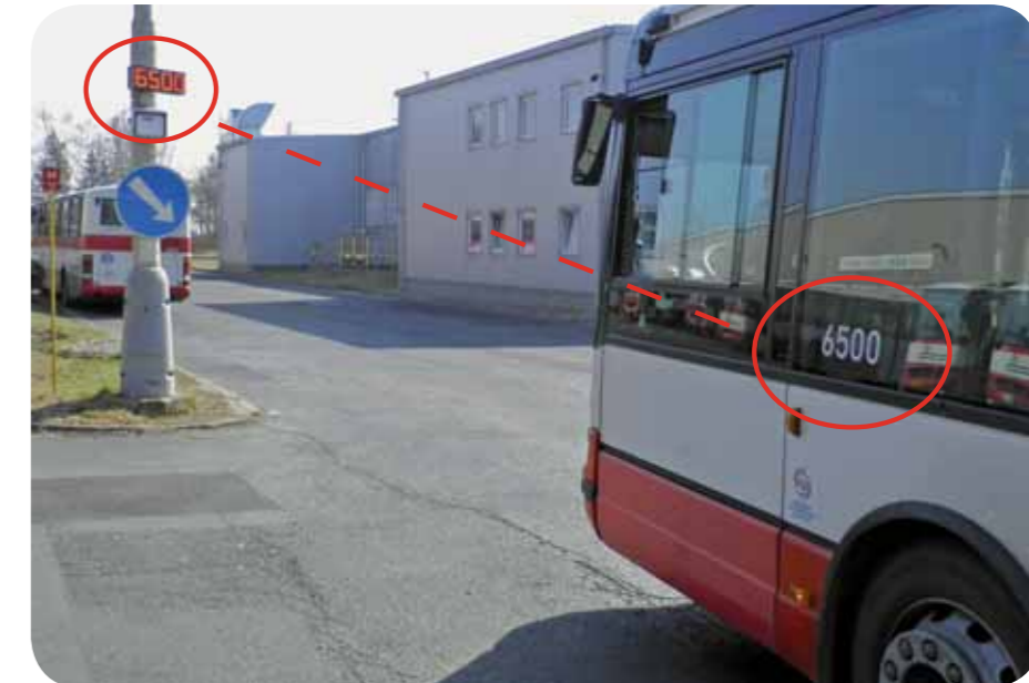
Autobus projíždí kolem kontrolního zařízení na vjezdové vrátnici. Na panelu se zobrazuje evidenční číslo vozu
