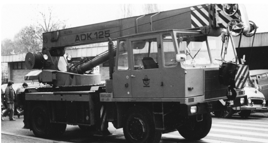
Názorný příklad použití autojeřábu v praxi. Tatra 138 při nakládání pražců ze zrušené provizorní tratě na Tábořské ulici v blízkosti stanice Na Paloučku. 27. září 1970
