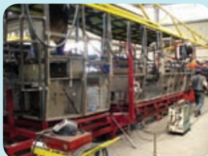
Svářeči kouzlí z hromady profilů autobusovou konstrukci.
