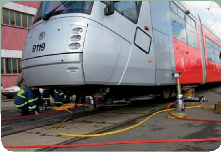
Zvedání tramvaje 14T pomocí hydraulických zvedáků
