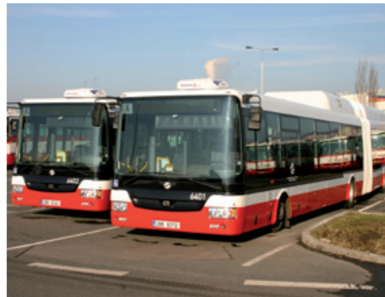
Většina elektro výzbroje je umístěna na střeše: baterie, proudový měnič ze stejnosměrného zdroje na střídavý proud a jeho chlazení. Kombinace pohonu z bateriového zdroje a spalovacího motoru vysvětluje, proč je v názvu slovo hybridní.
