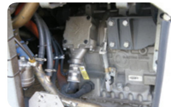
Do rozměrů standardní převodovky se podařilo vměstnat dva elektromotory. Převodovka se chová jako elektricky variabilní. Funguje jako dvoustupňová, pro nízkou a vysoké rychlosti. Paralelní proto, že může kombinovat souběžně dva toky výkonu přes převodovku na výstupní kroutící moment.
