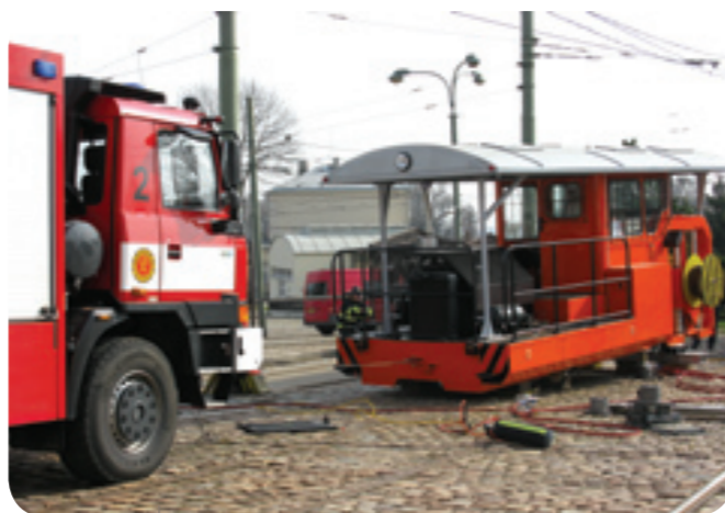
Jištění zatlačovačky navijákem technického automobilu
