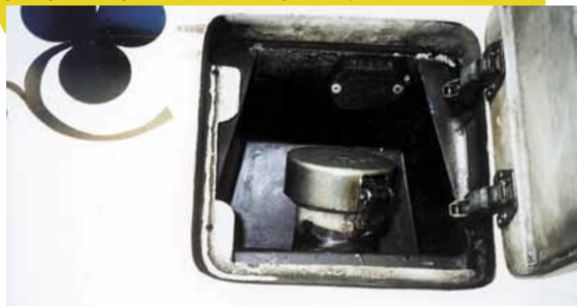
Hrdlo palivové nádrže autobusu. Nad hrdlem je čidlo, které spolu s čidlem na výdejní pistolí předává do počítače informaci, kolik paliva daný autobus natankoval.
