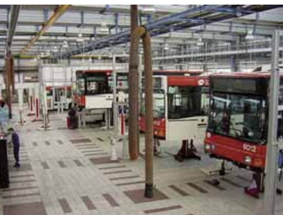
Opravná autobusů, v popředí jsou hadice na odsávání výfukových plynů. Po žluté kolejnici ve stropě vozí jeřábová kočka díly přímo ze skladu.
