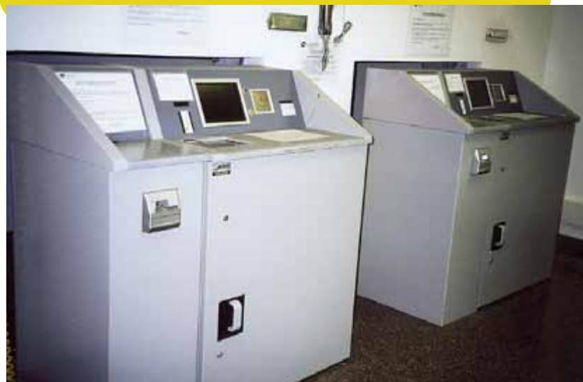
Za prosklenou stěnou výpravny jsou tři takovéto automaty. Řidič vloží do automatu svoji identifikační kartu, dále vloží bankovky a vysype drobné, které vybral za jízdenky. Navolí, kolik a jakých jízdenek chce vydat a zároveň s jízdenkami obdrží stvrzenku o provedené transakci. Vstup do této místnosti je pouze na identifikační kartu.
