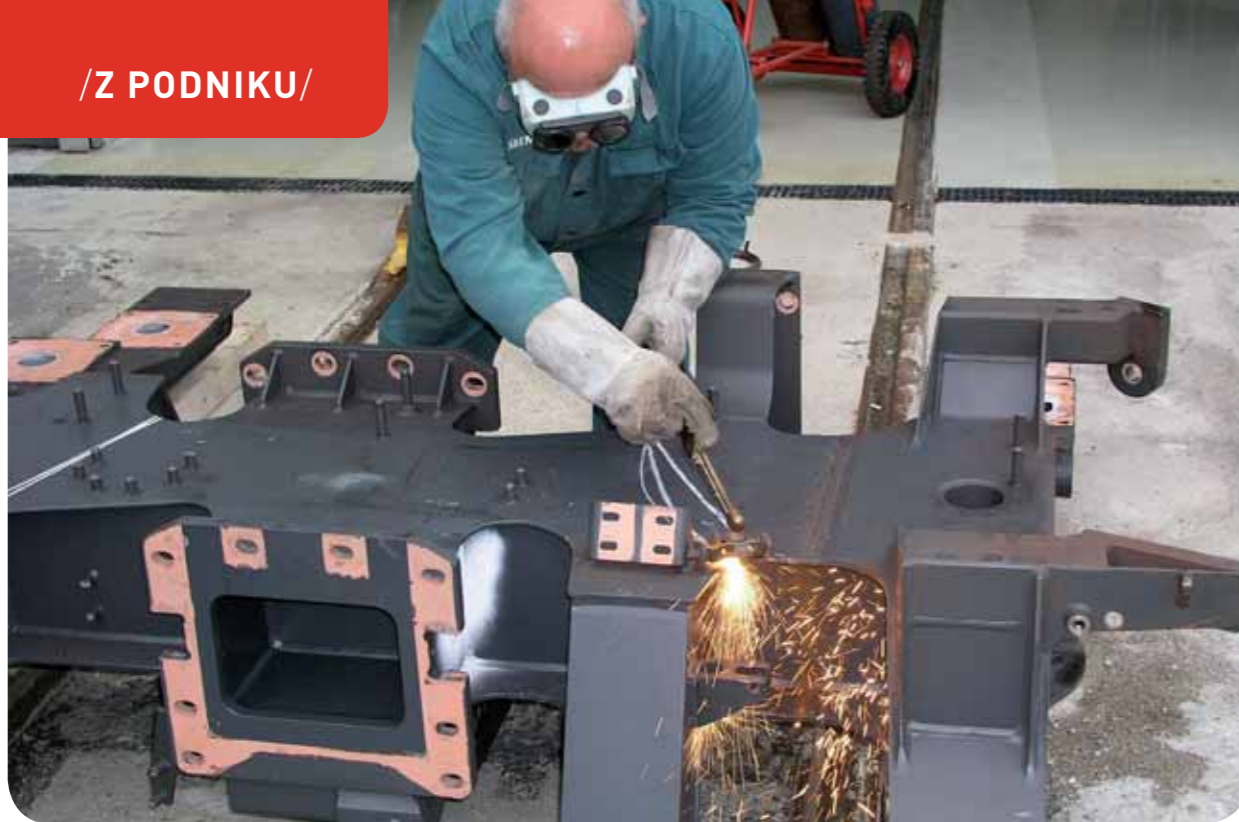
Rožezávání rámu č. SIE 173972 pro zkoušky prováděné ve Výzkumném ústavu železničním
