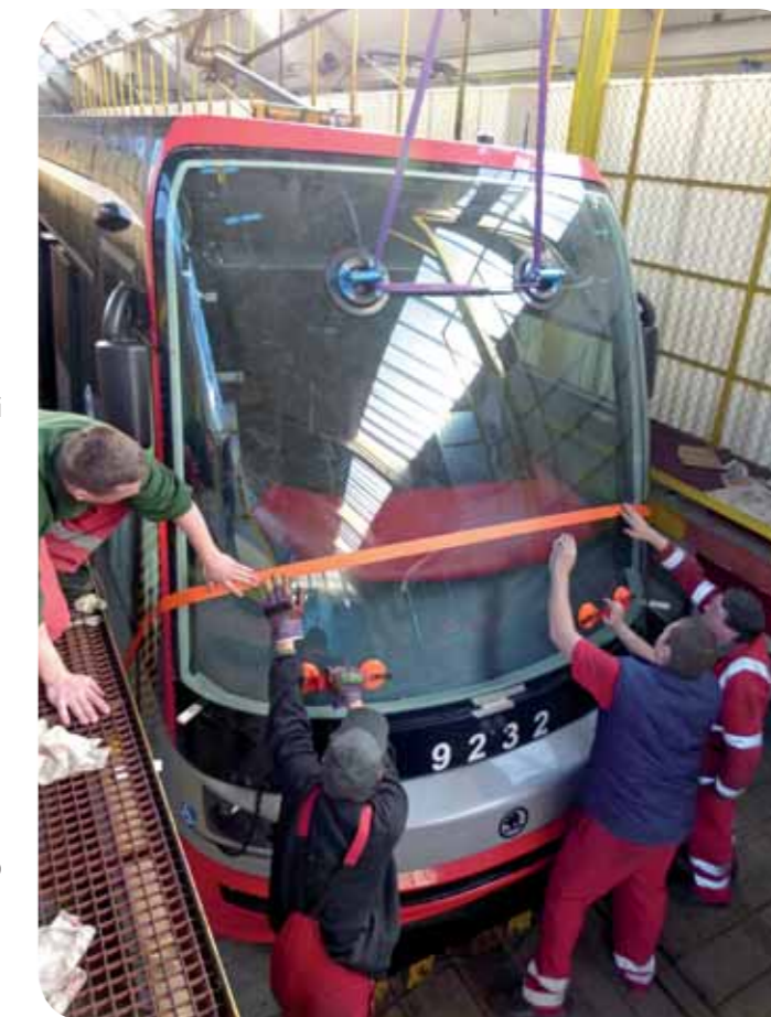
Hmotnost skla a dodržení technologického postupu vyžaduje při výměně skla účast party zámečnicků
