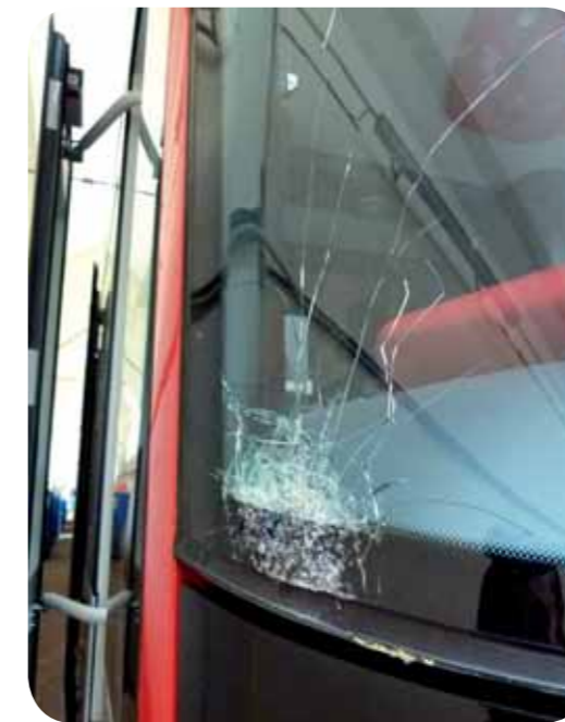
Detail praskliny čelního skla tramvaje 15T ForCity před výměnou
