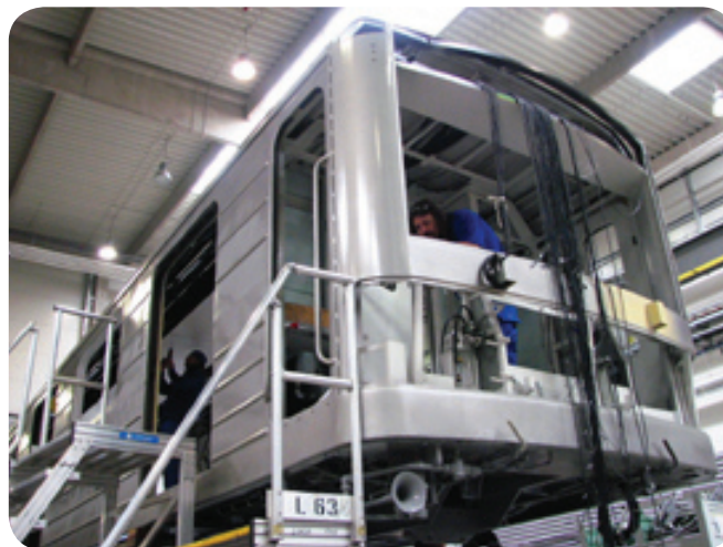
Montáž vybavení kabiny strojvedoucího
