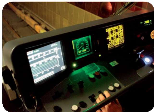
↑ Systém LZA, displej vlevo v kabině strojvedoucího slouží jako informační rozhraní se subsystémy ACBM3 a SOP2P.
